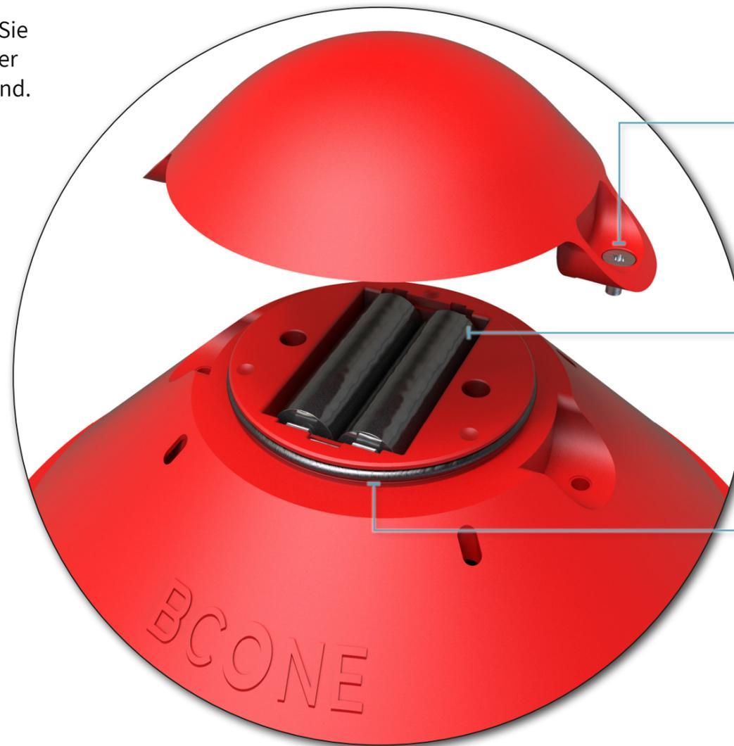
**A** Lösen Sie die beiden Schrauben mit einem 2-mm-Inbusschlüssel (5/64") und nehmen die Abdeckung ab.
